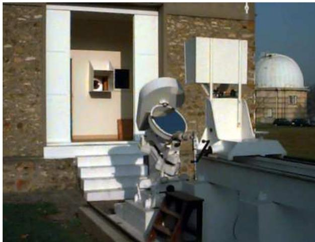
*Fente du spectrographe (à gauche) et miroirs du coélostat (à droite)*
